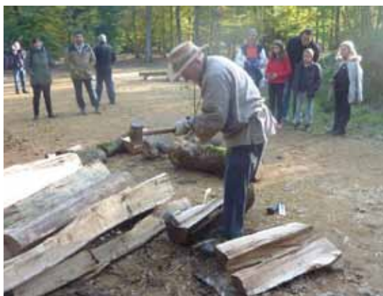
Taille d'une pièce de charpente
